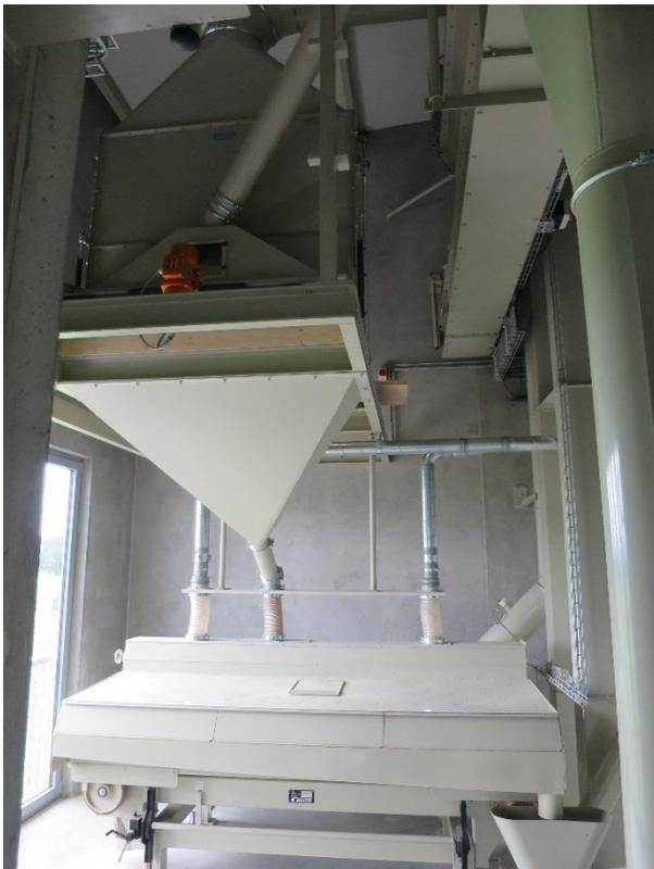
Links: Im Aspirationskanal werden die Spreuer (Schalenteile) abgesogen. Der darunterliegende Tischausleser trennt das geschälte und ungeschälte Korn.
